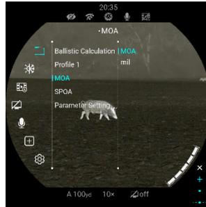
Ist SPOA auf „Absehen verschieben“ eingestellt, verschiebt das Gerät der ACE-Serie das ursprüngliche Absehen automatisch auf den vorgeschlagenen Zielpunkt.
