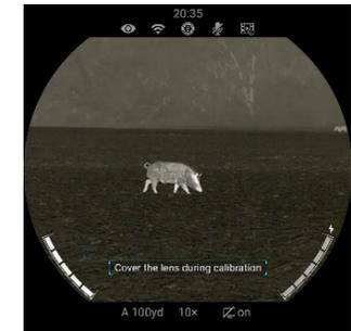
„Objektiv während Kalibrierung abdecken“. Schließen Sie den Objektivdeckel und die Hintergrund-Kalibrierung wird nach 2 Sekunden durchgeführt. Nachdem die Kalibrierung abgeschlossen ist, öffnen Sie den
